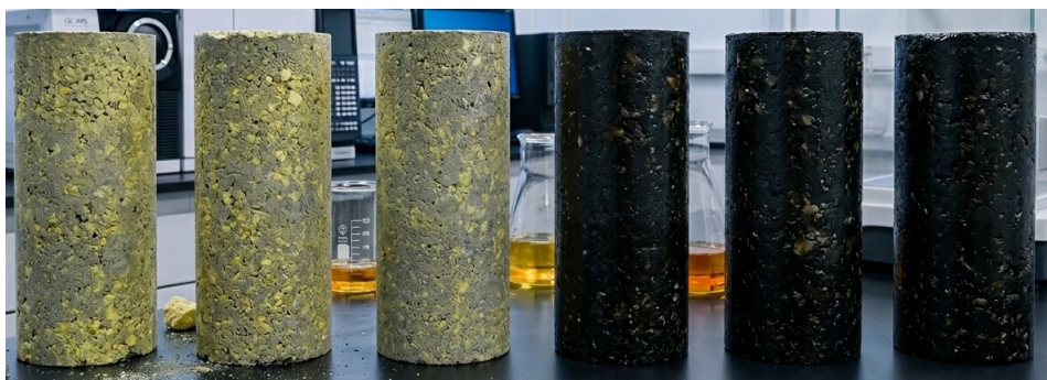
1-nji surat. Nebit galyndyly emulsiýalaryny ulanmak arkaly modifisirlenen kükürt-asfalt-beton birleşmeleriniň nusgalary
