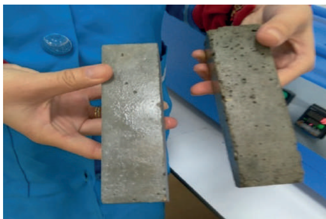
2-nji surat. Duzly erginde saklanan pussolanaly (çepde) we adaty nusgalaryň tapawudy
