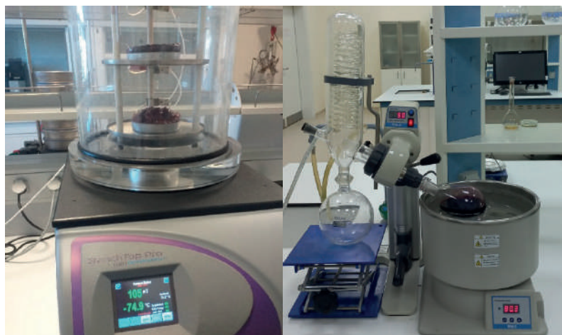
2-nji surat. Liofilizator we wakuum aýlaýjyly bugardyjy arkaly ekstraktyň toz we pasta ýagdaýyna getirilişi
