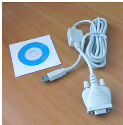
3-nji suart. Birikdirji programma üpjünçiligi bilen USB-COM adapteri we CD-ROM üçin
