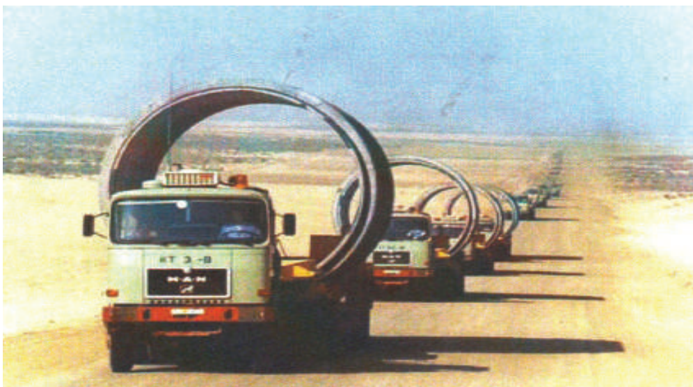
Рис. 1 Транспортировка звеньев трубопровода
