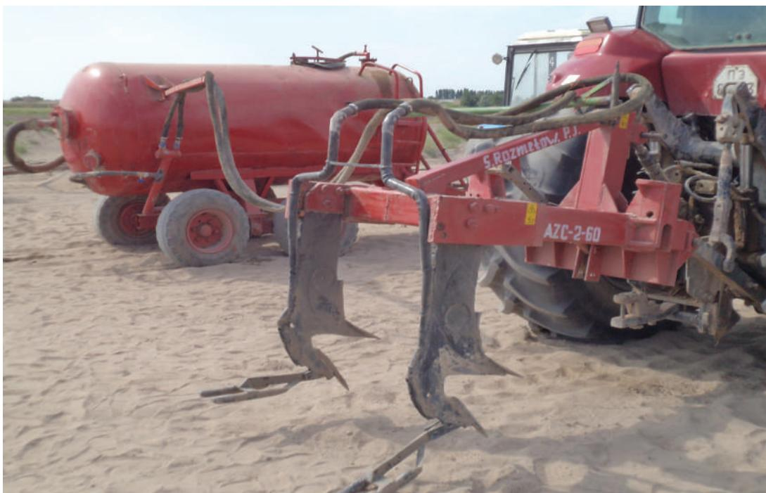
*Рис 2. Комбинированное устройство (НАД-2-60М (АЗС-2-60К)) для глубокого рыхления грунта с одновременным внутрипочвенным внесением жидких органоминеральных удобрений*
