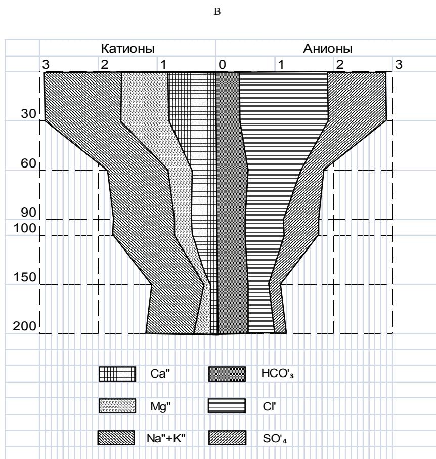
*Рис.* Солевой профиль почвы защитного участка по данным трёх проб: а) первая; б) вторая; в) третья; на ординате показана глубина профиля, справа – содержание анионов в миллиэквиваленте в порядке возрастающей растворимости солей со щелочноземельными катионами, слева – катионов по тому же принципу
