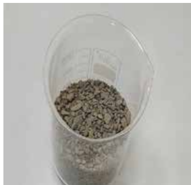
3-nji surat. Düzümi, galyndy kauçuklar we galyndy polietilenterefalat bilen modifisirlenen asfalt betonynyň nusgasy
