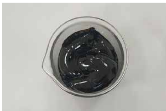
1-nji surat. Galyndy polimer we rezin bilen modifisirlenen bitum
