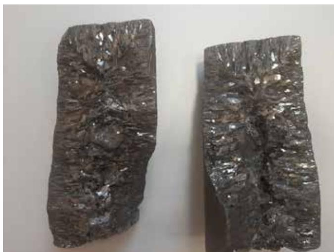
Wismut telluridi emeli usulda ösdürilýän kristaldyr. Şeýle kristaly ösdürmek için eredilen wismutyň içine tellury goşmaly we onda tellury eretmeli, ýagny wismutdaky telluryň erginini almaly. Wismut hem adatça suwuklyklarda bolşy ýaly tellury belli bir möçberde eretmäge ukyplydyr. Düzümindäki tellury artdyryberseň ol doýgun hala çykýar we artykmaç tellur
