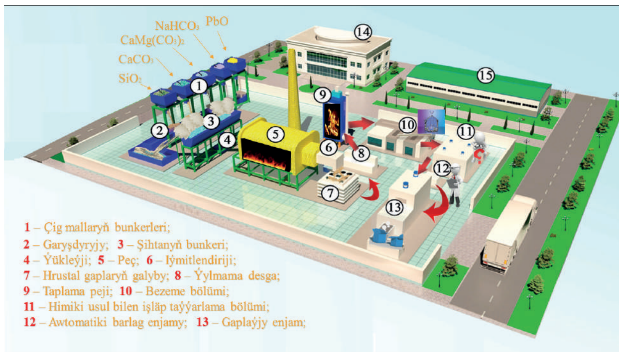
1-nji surat. Hrustal önümleri öndürmek üçin tehnologi shema
