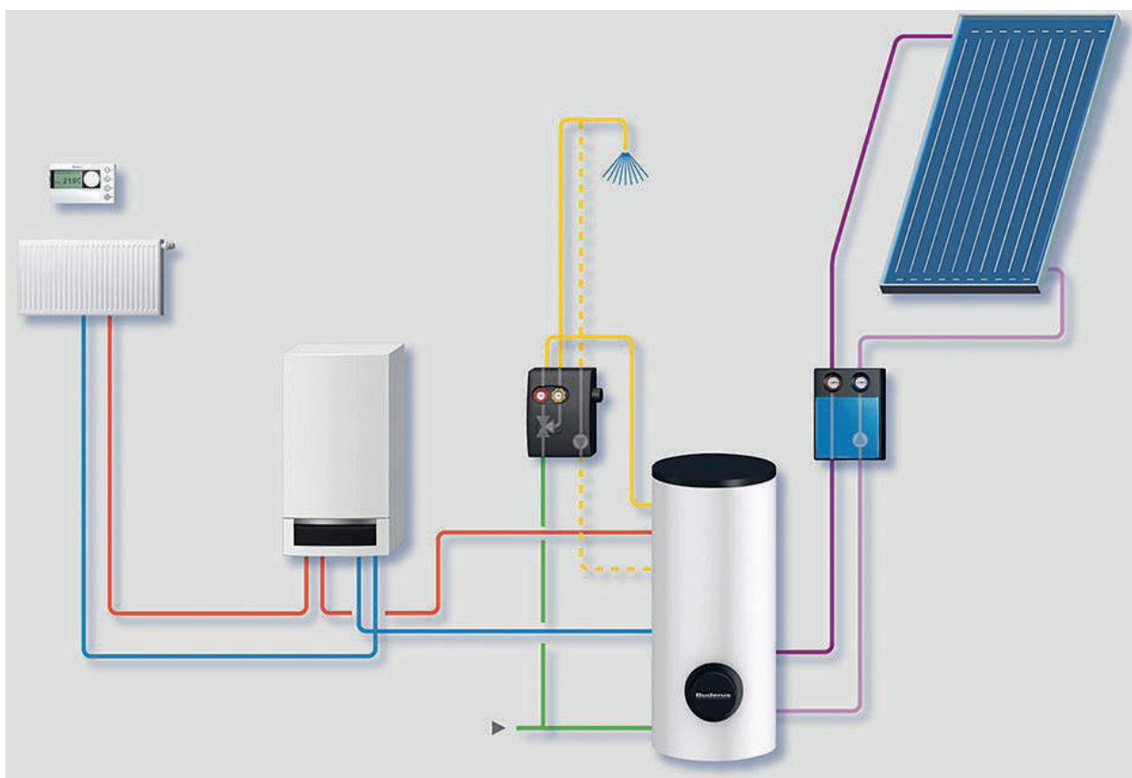
3-nji surat. Gün kollektorynyň utgaşdyrylan ýagdaýdaky birikdiriliş shemasy
