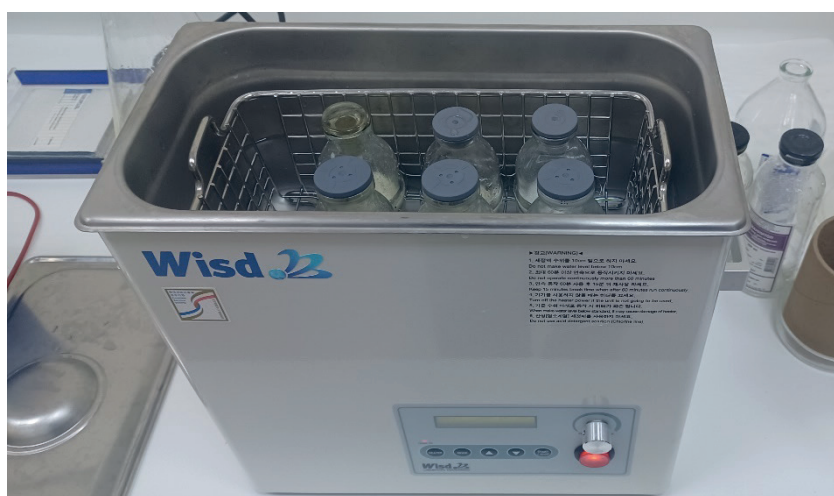
2-nji surat. Nanoemulsiýalaryň ultrasesli hammamda taýýarlanylş prosesi
