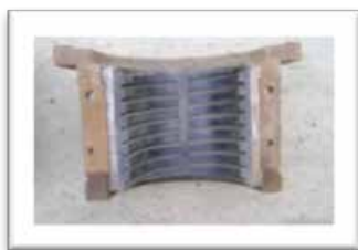
1-nji surat. Typma podşipnigiň daşky korpusy. a) “3825-ВР” markaly rezin işlikli typma podşipnik, b) “1-1400-4-ТК-300-6-2-А (ТДС 20-93)” markaly rezin çeki
