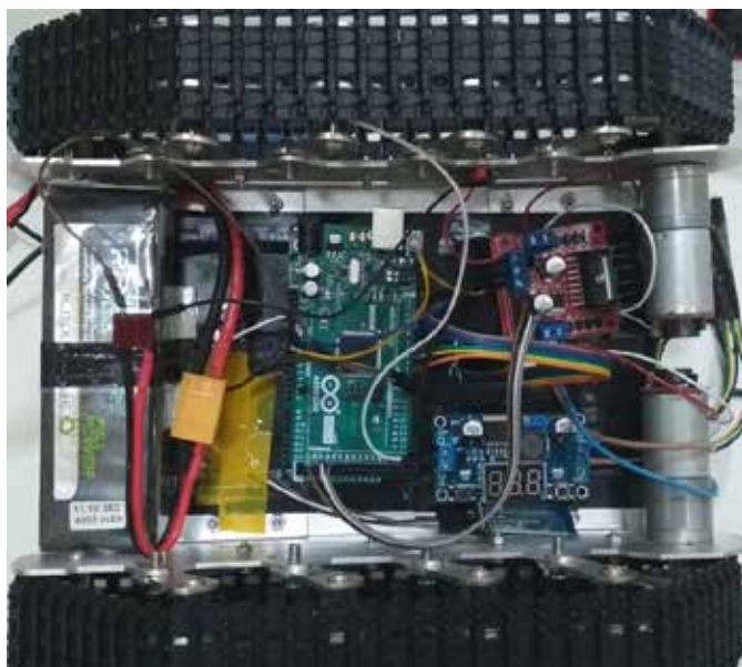
2-nji surat. “Arduino Mega” platformasy arkaly elektron enjamlarynyň özara birleşdirilişi
