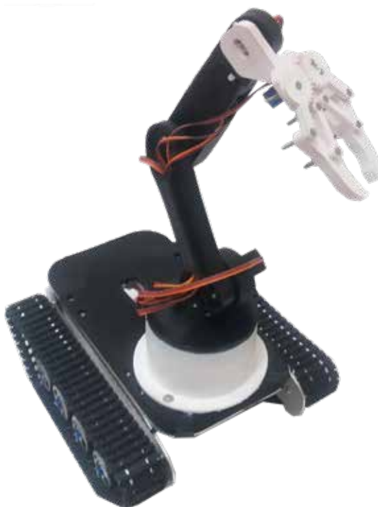
8-nji surat. Tehnologiyasy işlenip taýýarlanylýan, simsiz “Android” programmasy bilen dolandyrylýan mobil robot golunyň umumy görnüşi
