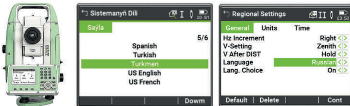
1-nji surat. “Leica Flex Line-TS-07” kysymly elektron-lazerli taheometri we onuň dil saýlama penjireleriniň görnüşleri
