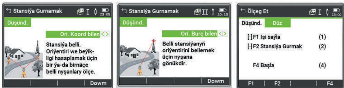
3-nji surat. “Leica Flex Line-TS-07” taheometriň monitorynda stansiýany (bekedi) gurmak penjirelerinden alnan şekiller
